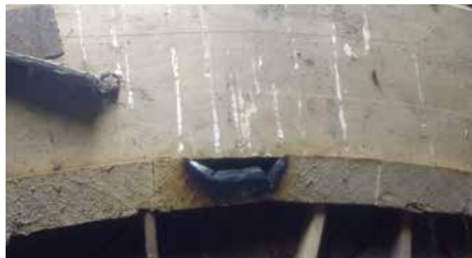
Een van de verbrande belegstukken van het bovenwiel
