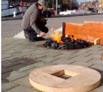
De ijzeren banden worden om de iepenhouten schijven van de steenschijfloop gekrompen
