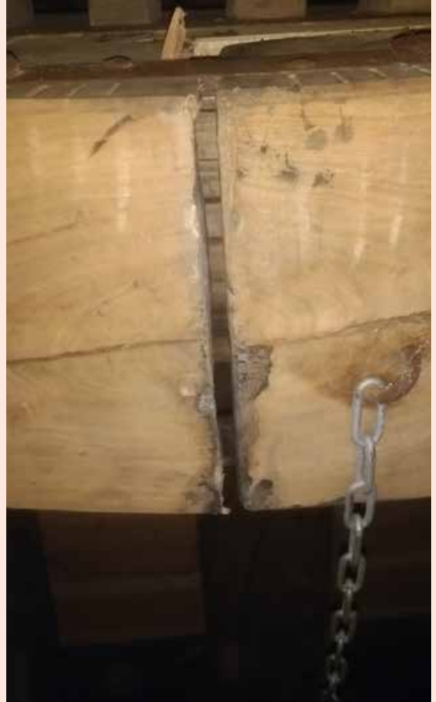
Ruimte tussen de vangblokken gezaagd, zodat het stof op de vloer valt
