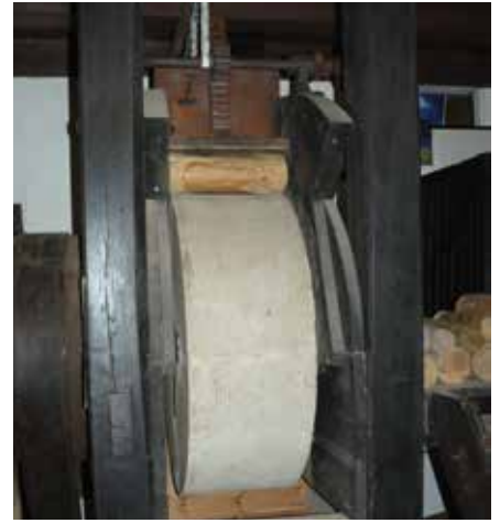
De slijpsteen met het houtblok dat tot pulp wordt geslepen
