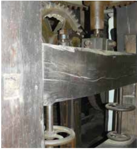
De bolspil van de raffineur met onderaandrijving want het is een waterradmolen
