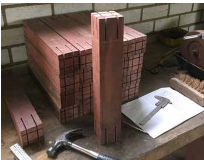
Even wat hout er af en de staven voor het rondsel liggen klaar. De molen heeft alleen een bovenrondsel: onder heeft Dekker een geheel stalen overbrenging aangebracht.
