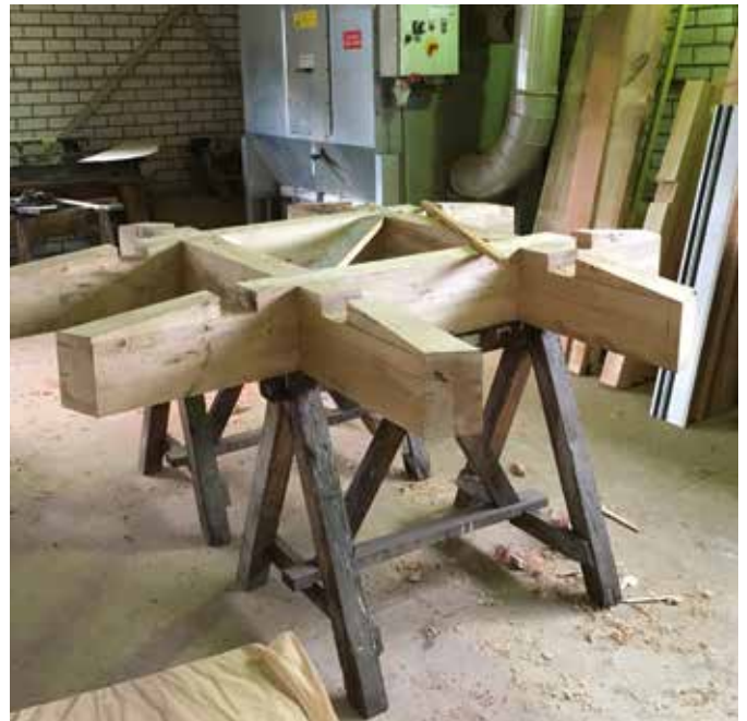
De kruisarmen van het bovenwiel. Duidelijk is dat we het hier hebben over één van de kleinere wipmolens van Nederland (18,10 meter vlucht).
