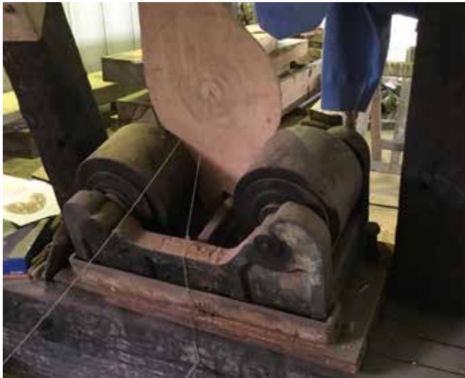
Het dekker-halslager komt weer terug. Te zien is hoe Max Beijck bezig is geweest met het uitmeten van de nieuw te gieten bovenas.
