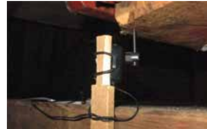
Sensor (reed-contact) en magneetje onder bij koningsspil
