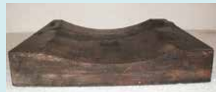
Zijkanten 42 mm hoog, asholte 27 mm op diepste punt
