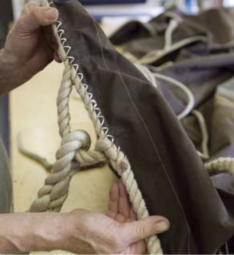
Bevestiging van het touw aan het zeil
