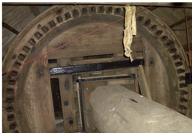
Houten bandvang stadsmolen Hulst wordt gesmeerd met reuzel
