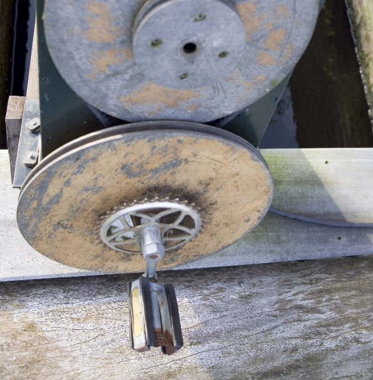
Door middel van het fietspedaal, kun je met de hand de tonmolen laten draaien
