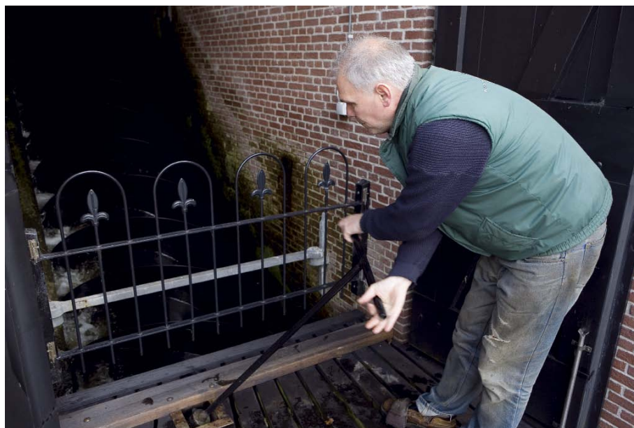
Jan Hofstra demonstreert de werking van de klep m.b.t. de waterbelasting van de vijzel
