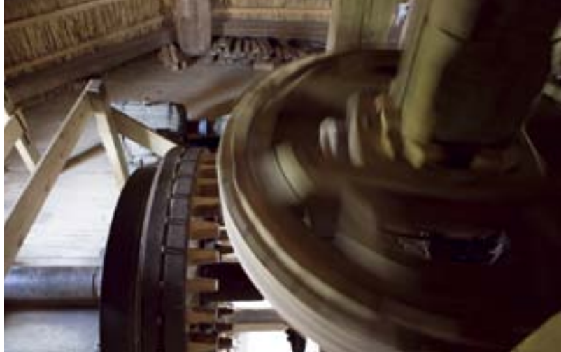
Bonkelaar draait, krukas wiel niet, krukas staat uit zijn werk
