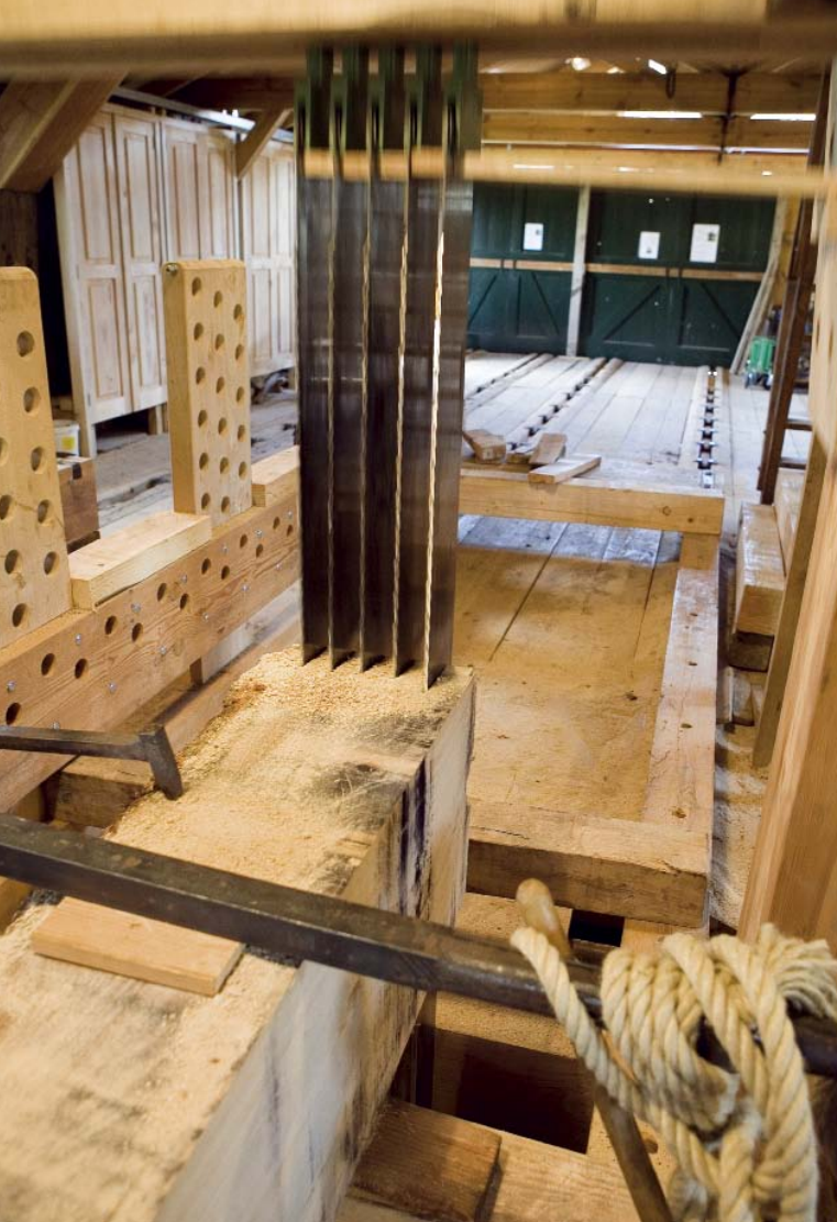
Zagen m.b.v. de elektromotor
