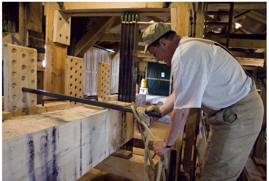
Stam wordt op de zaagslede vastgezet
