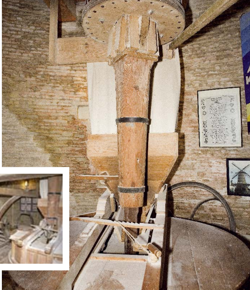
Steenkoppel met –spil en rondsel, dat aangedreven wordt d.m.v. het spoorwiel
