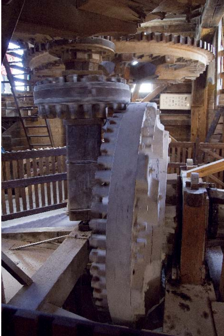
Het wentelwiel wordt aangedreven d.m.v. de koningsspij, waar een bonkelaar op bevestigd is
