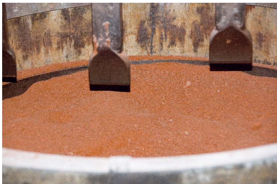
De kapperij. De ton draait rond d.m.v. het krabbelwerk
