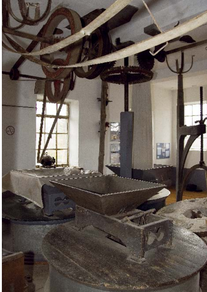
Begane grond, 4 koppels stenen, waarvan de één in de steenkraan hangt, linksachter de dynamo, die met een drijfriem door de as onder het plafond aangedreven wordt
