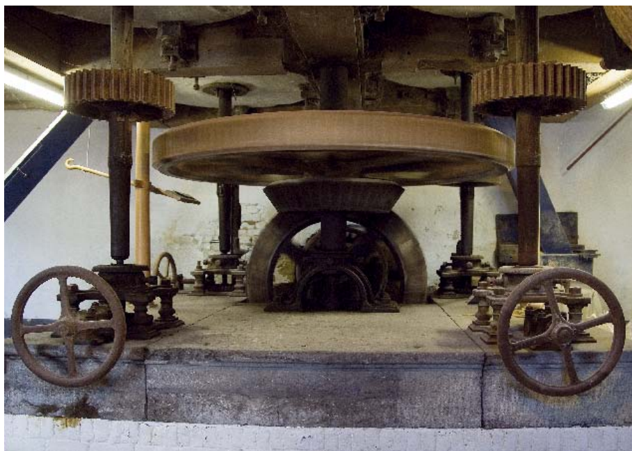
4 steenspillen met daartussenin het draaiende spoorwiel, daaronder de overbrengingen naar de wateras, links de gele 'afremmer'
