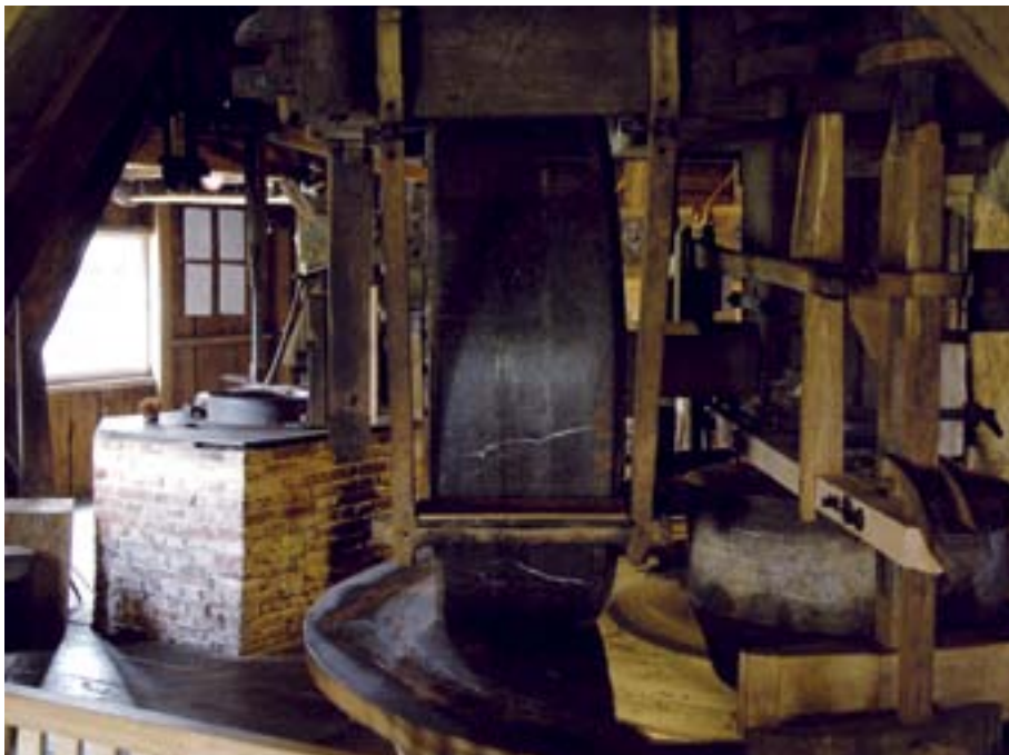
De kollergang, waar het lijnzaad onder de zware kantstenen geplet wordt
