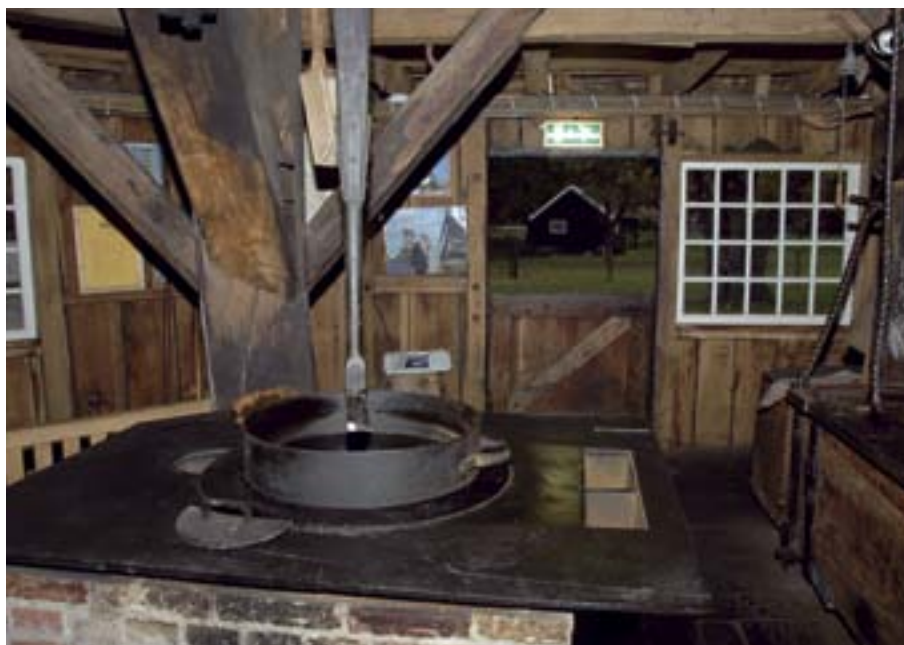
Het vuister waarop het lijnzaad in een bodemloze pan verwarmd wordt
