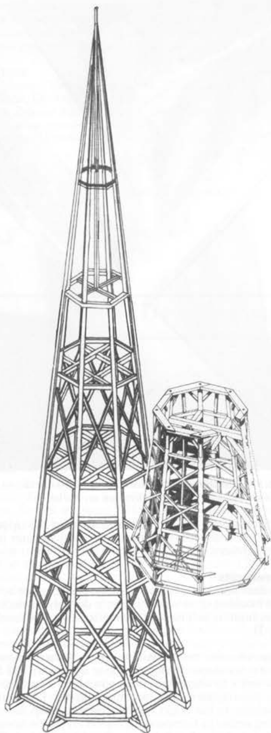
Afb.1 Achtkante torenspits. Tekening naar het origineel van Friedrich Ostendorf.
