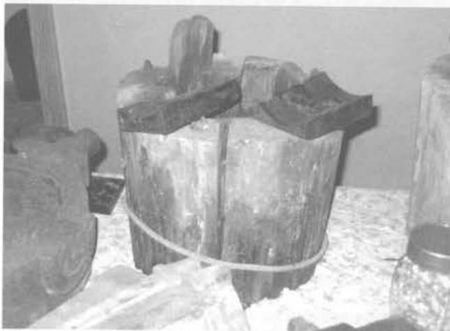
Een houten steenbus met bijbehorende pokhouten neuten en stelwig.
