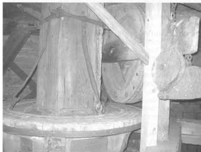
De luitafel met de weinig voorkomende hangijzers voor dit molenonderdeel.
