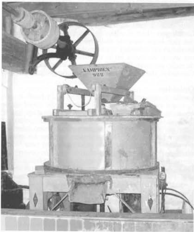
Maalstoeltje voor gebruik op een boerderij, aangedreven door een landbouwtrekker. Nu wordt het geheel met een elektromotor aangedreven.
