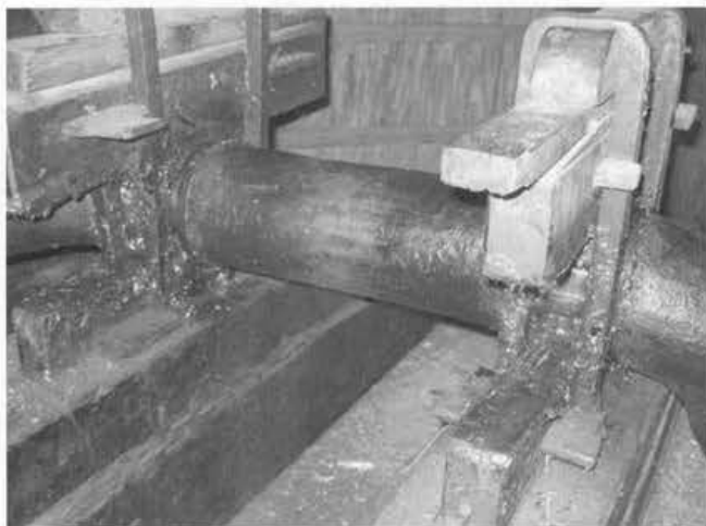
De krukas gelagerd in de krukpollen op de krukszolder.
