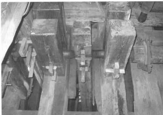
De krukas van De Eenhoorn, gelagerd in de krukpollen op de krukzolder
