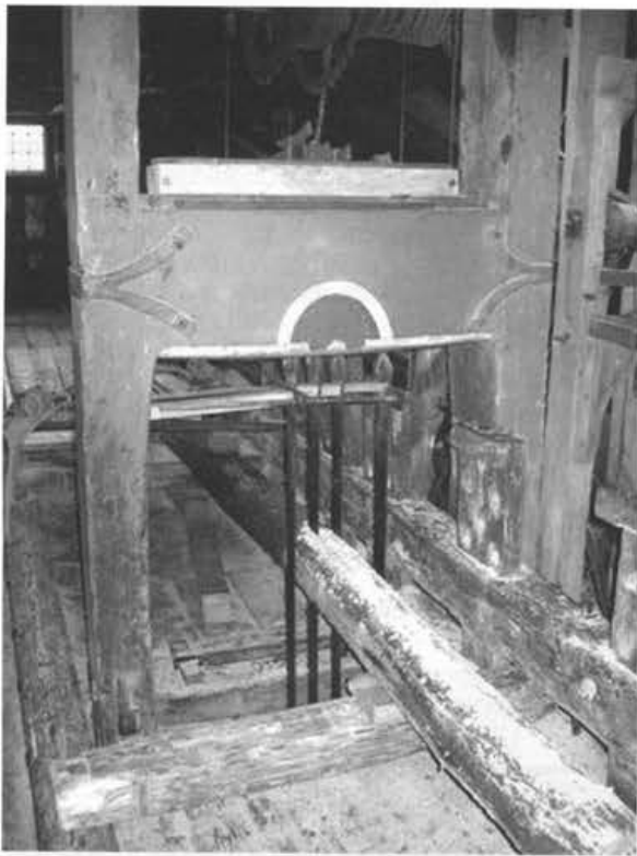
Een der zaagramen met vier ingespannen zagen.
