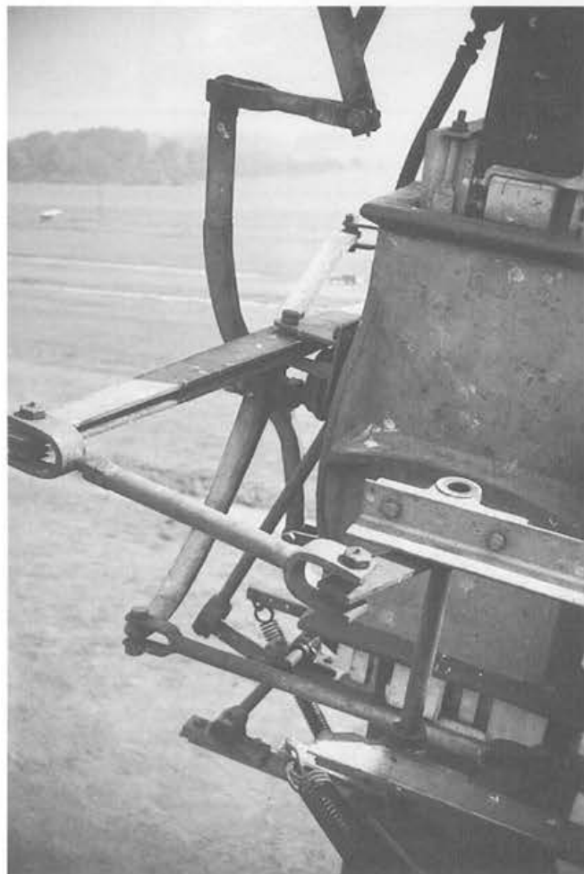
De uiterst ingewikkelde spin voor de askop met vele trek- en duwstangen, kniehefbomen regelveren, enz.
