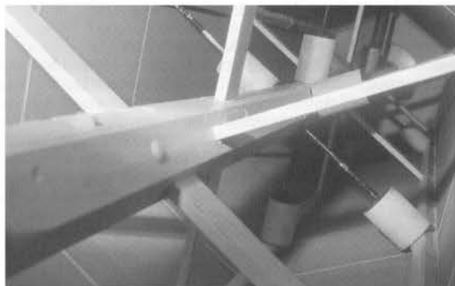
Een blik in de hamerbuil van "De Hoop en Verwachting". De cilindervormige klossen glijden over metalen buizen heen en weer, als de buil in beweging is.
