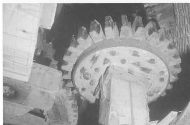
Eén steenspil wordt door een sterrewiel aangedreven.
