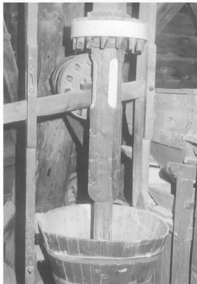
De spil, die d.m.v. een kleine bonkelaar de buil aandrijft. De buil wordt op dezelfde wijze in het werk gesteld als een kammenluiwerk.
