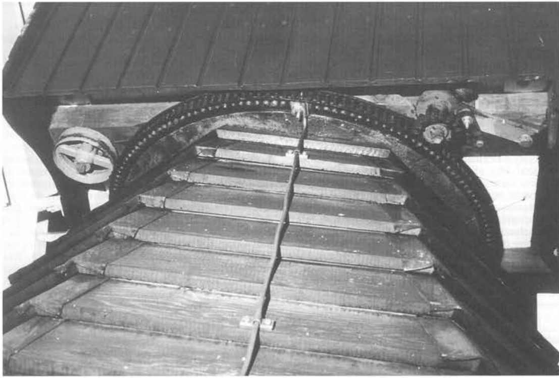
Gedeelte van het kruimechanisme van de lattenzager te Wedderveer
