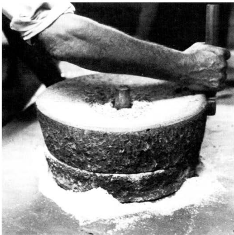
afb. 6 Een rechtshandige kon meer kracht op de looper van zijn handmolen uitoefenen, wanneer hij linksom draaide. Rechtsom draaien werkte vermoeiender en zou hij (of zij) minder lang volhouden. [foto Drents molenboek, pag. 33]
